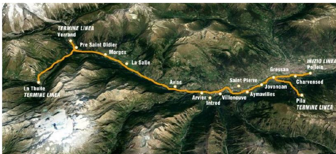
FIGURA 45 – Sviluppo della rete di trasporto gas metano Pollein/Pila/Valdigne [Fonte: Comune di Aosta 223 ]
