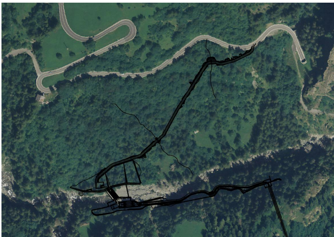
Torrente Ayasse – Nuovo tracciato della viabilità di cantiere tra la presa principale sul torrente Ayasse e la SR 2
