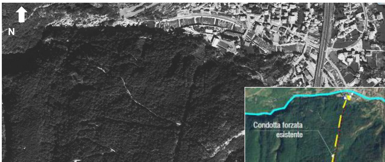
Hone, veduta aerea dell'area interessata dalle opere a progetto. In particolare, sono visibili la condotta esistente e i fabbricati relativi alla centrale (PNG 1994, scala 1: 5.000). Nel riquadro in basso a dx sono indicate le opere a progetto previste in quest'area come da Relazione tecnico descrittiva.
