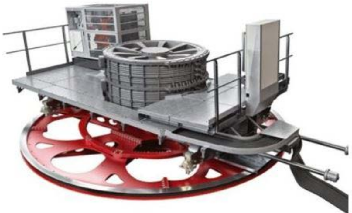
Figura 11. Argano principale del tipo ad azionamento diretto. Esempio sistemi adottati dalla ditta Leitner e dalla ditta Doppelmayr.
