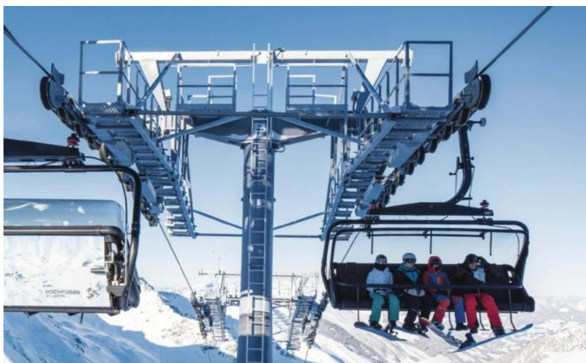
Figura 16. Esempio testata con rulliere di linea impianto marca Doppelmayr.
