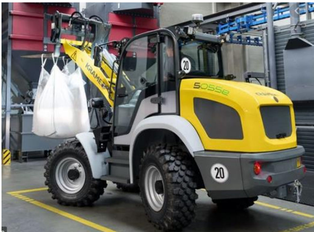
Immagine 23 – pala gommata elettrica Kramer 5055 e
