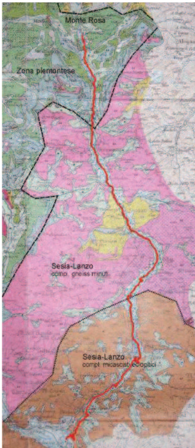
Figura 2: schema geologico della valle di Gressoney con indicazione del tracciato e suddivisione delle principali unità tettoniche come descritte nella relazione (estratto da Carte géologique de la Vallée d'Aoste- G. Elter).
