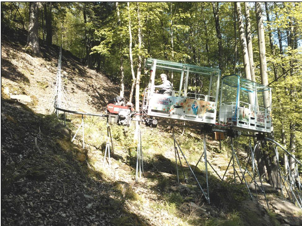
**Fig.10-6 – Esempio convoglio a 2 vagoni con copertura semi-integrale su monorotaia a cremagliera**
