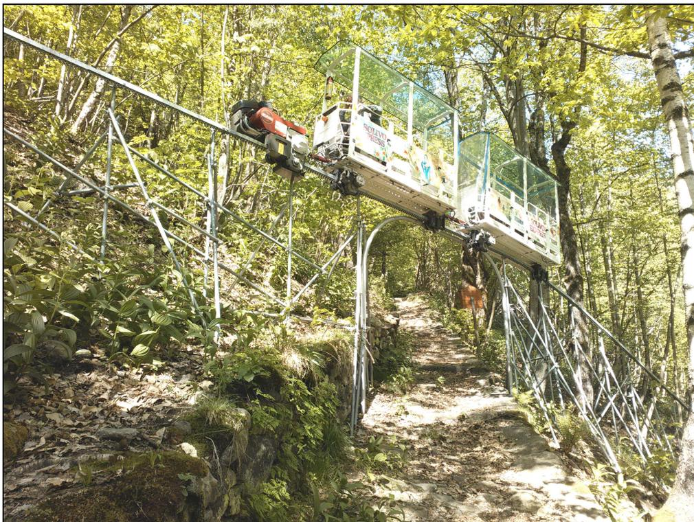
**Fig.11-5 – Esempio convoglio a 2 vagoni con copertura semi-integrale su monorotaia a cremagliera**
