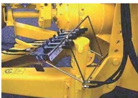
Esempi di protezione delle leve contro l'azionamento accidentale
