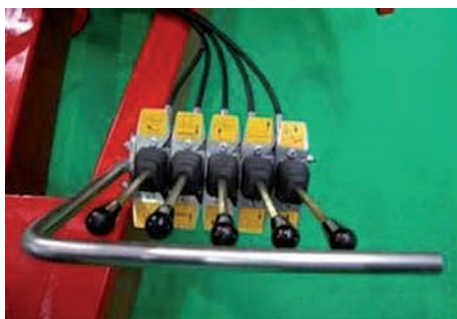
Esempi di protezione delle leve contro l'azionamento accidentale
