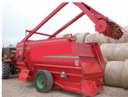
Organi di taglio e di carico in posizione sollevata: parete mobile in posizione abbassata e organi di miscelazione e/o trinciatura in movimento protetti
