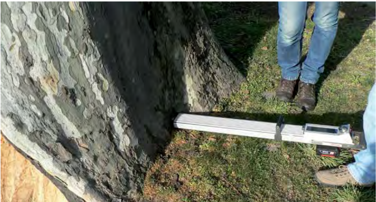
Prova penetrometrica con resistograph sul colletto di un platano monumentale (foto autori)
