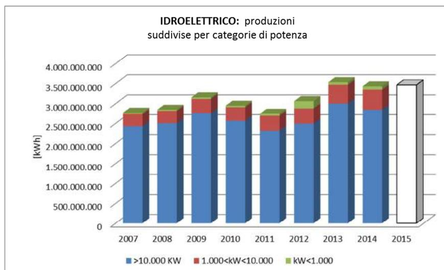
Figura 122: IMPIANTI IDROELETTRICI andamento della produzione suddivisa per categorie di potenze degli impianti (elaborazione dati fonte GSE Simeri)
