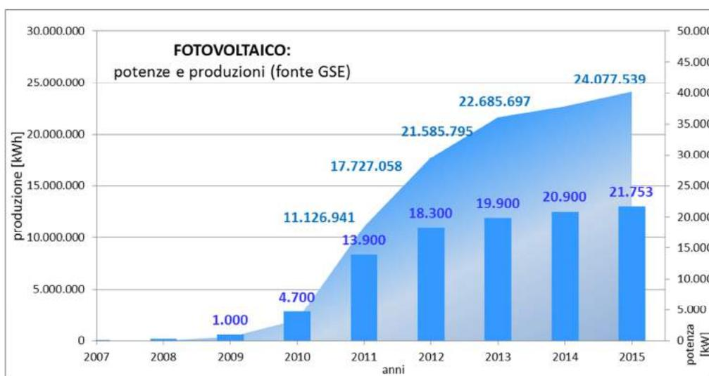
Figura 128: IMPIANTI FOTOVOLTAICI – andamento delle potenze e produzioni
