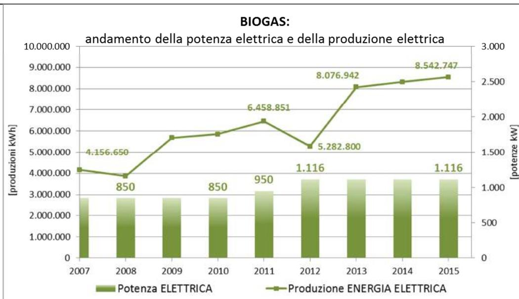
Figura 129: IMPIANTI A BIOGAS – andamento delle potenze e produzioni di energia elettrica – raccolta dati a livello regionale
