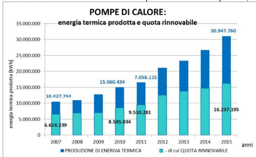
Figura 161 POMPE DI CALORE: andamento dell'energia termica prodotta e della quota parte di energia rinnovabile
