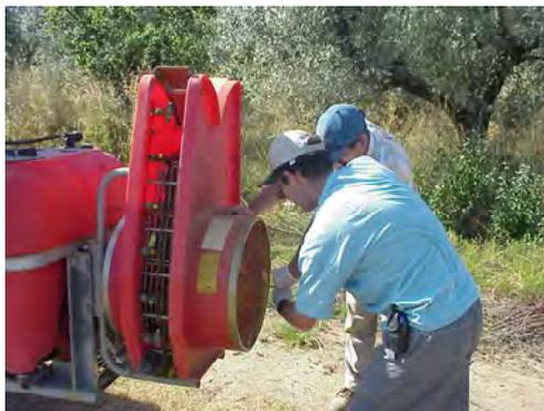
Fig. 49 – Regolazione dell'inclinazione delle pale.
