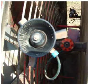
Fig. 82 - Esempio di ugello rotativo per atomizzatori
