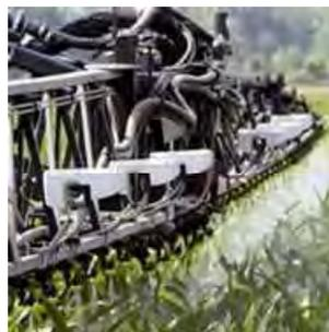
Fig. 61 - irroratrice dotata di sensori per l'identificazione del bersaglio.
