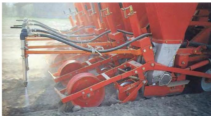
Fig. 59 – Irroratrice per diserbo localizzato abbinata a seminatrice.
