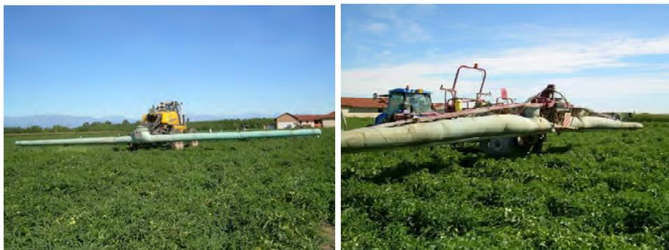
Fig. 69 - Barre irroratrici equipaggiate con manica d'aria
