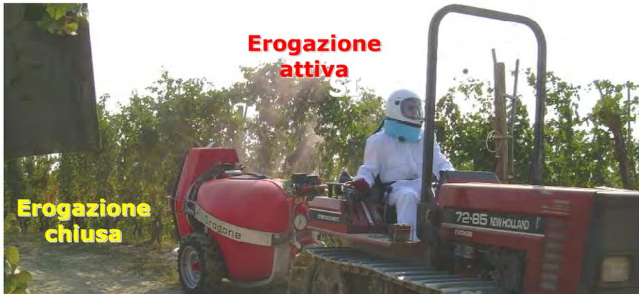
Fig. 37 – Interruzione dell'erogazione sul lato esterno dell'ultimo filare dell'appezzamento.
