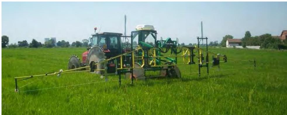
Fig. 24 – Impiego di barra umettante contro il riso crodo (foto: MAR sas - Ronsecco – VC).
