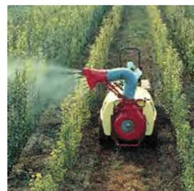
Fig. 41 – Irroratrice con cannone impiegata in vigneto.
