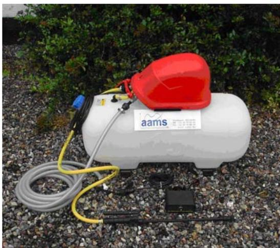
**Figura 63:** Kit portatile per il lavaggio dell'irroratrice dotato di una pompa elettrica ausiliaria e di un serbatoio per l'acqua pulita. Questo sistema consente di operare il lavaggio "in continuo", immettendo nell'irroratrice acqua pulita ed al contempo mantenendo in funzione la pompa principale dell'irroratrice, in modo tale da erogare la miscela fitoiatrice diluita attraverso gli ugelli.
