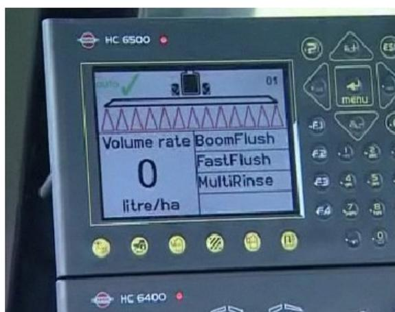
**Figura 63: Pannello di controllo di una barra irroratrice equipaggiata con un sistema automatico per il lavaggio interno. È possibile selezionare la parte della macchina (solo serbatoio, solo tubazioni, intero circuito idraulico) che si intende risciacquare con l'acqua pulita del serbatoio lava impianto.**
