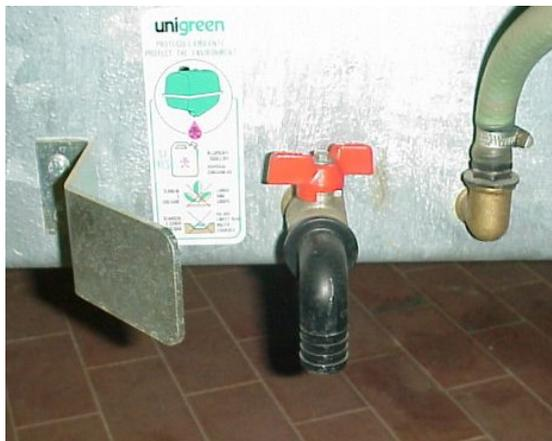
**Figura 10:** *Valvola per lo svuotamento del serbatoio principale posizionata in maniera tale da poter raccogliere tutto il liquido residuo nella cisterna in condizioni di sicurezza per l'operatore e per l'ambiente.*
