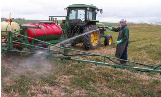
**Figura 8:** Esecuzione del lavaggio esterno dell'irroratrice direttamente in campo grazie all'impiego di una lancia a mano collegata con il serbatoio lava impianto dell'irroratrice (foto VISAVI).
