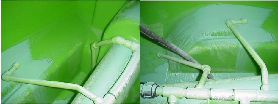
**Figura 35: Serbatoio caratterizzato dalla presenza di aree con evidente accumulo di residui a fine trattamento.**
