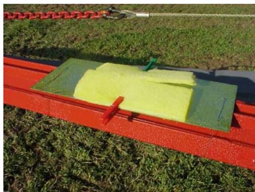
**Figura 39:** Esempio della contaminazione di captatori posizionati sul telaio di una barra irroratrice. Risulta evidente la presenza di depositi consistenti sulla superficie esterna della barra che supporta gli ugelli.
