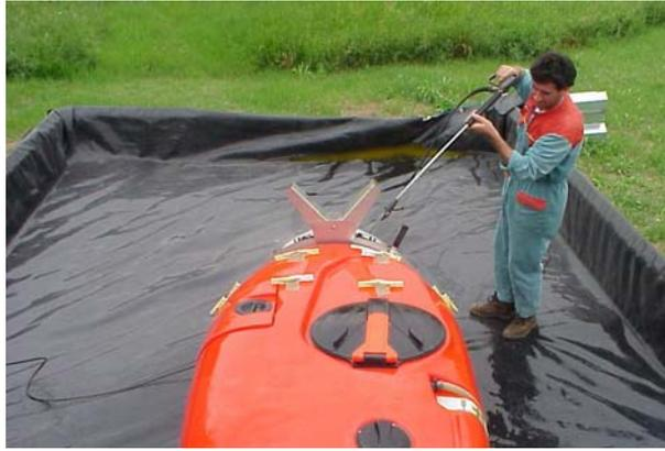
**Figura 22:** *Lavaggio dell'irroratrice su piscinetta con impiego di una lancia a mano alimentata dalla rete idrica aziendale.*
