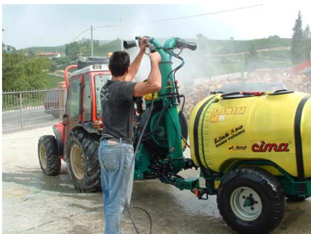
**Figura 51:** Utilizzo di un'idropulitrice per effettuare il lavaggio esterno dell'irroratrice.
