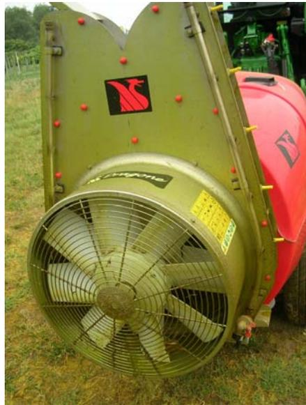
**Figura 40:** Contaminazione esterna di un'irroratrice ad aeroconvezione per colture arboree, particolarmente evidente sulle parti adiacenti al ventilatore.
