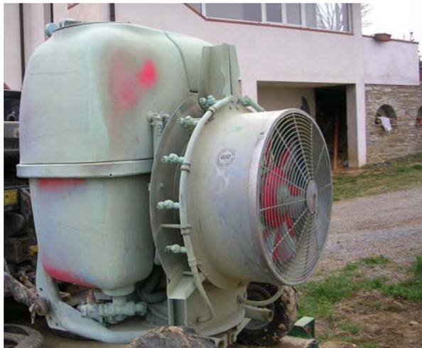
**Figura 14:** *I depositi di miscela fitoiatrica sulle superfici esterne della macchina irroratrice, se non rimossi, possono rappresentare una fonte di contaminazione per l'operatore e per l'ambiente.*
