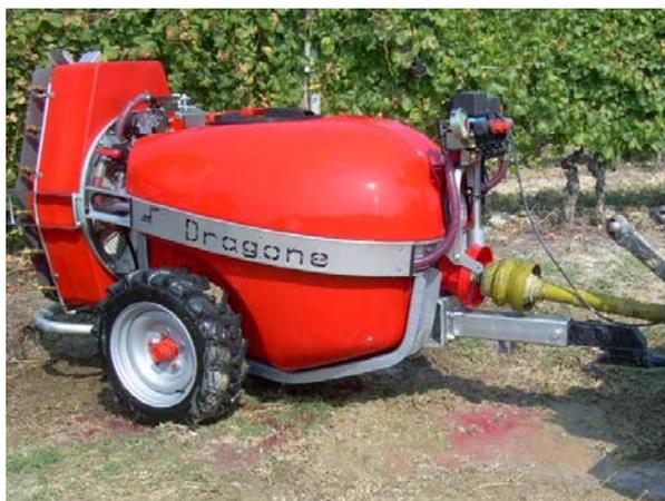
**Figura 12:** *Esterno del serbatoio di un'irroratrice: l'assenza di rugosità e di superfici schermate dagli altri componenti (es. gruppo di regolazione, pompa, ventilatore) agevola una pulizia più rapida e completa.*
