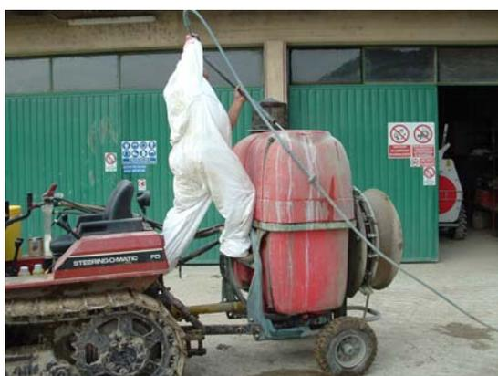
**Figura 50:** Utilizzo di un'idropulitrice per effettuare il lavaggio interno del serbatoio di un'irroratrice.
