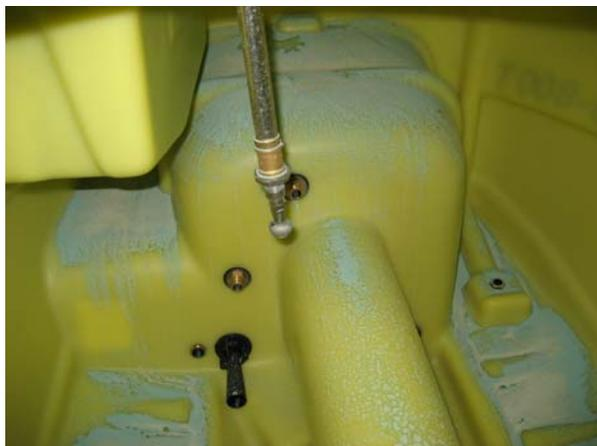
**Figura 28: Residui di miscela fitoiatrice sulle pareti interne di un serbatoio.**
