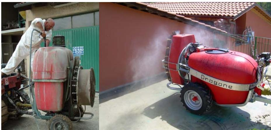
**Figura 61:** Dopo aver risciacquato l'interno del serbatoio con una lancia a mano o con un'idropulitrice, ed aver diluito il residuo di miscela fitoiatrica, quest'ultimo può essere raccolto attraverso la valvola di scarico del serbatoio. Quindi il serbatoio può essere nuovamente riempito con acqua pulita per risciacquare il circuito, attivando gli ugelli sull'area attrezzata.
