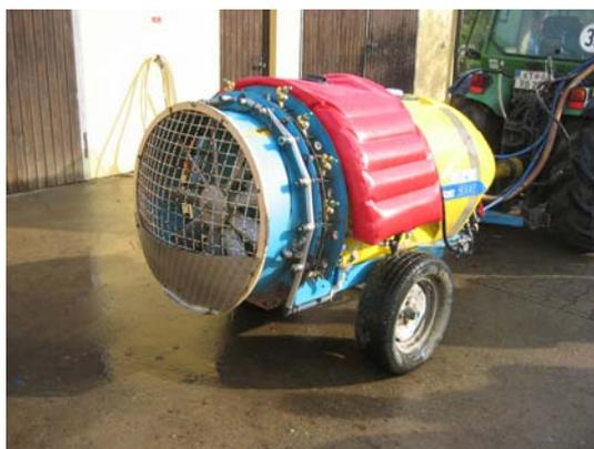
**Figura 44:** Esempio di serbatoio ausiliario per il lavaggio dell'irroratrice applicato sul corpo del serbatoio principale in una macchina originalmente priva di serbatoio lava impianto.
