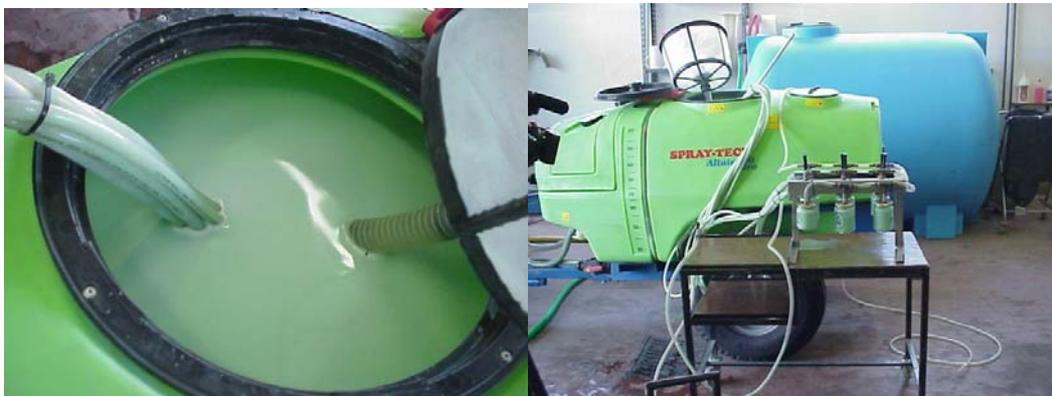
**Figura 36: Esecuzione di una prova di agitazione della miscela contenuta in un serbatoio impiegando una sospensione all'1% di ossicloruro di rame come materiale di prova.**
