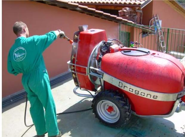
**Figura 1: Lavaggio di una macchina irroratrice su un'area attrezzata.**
