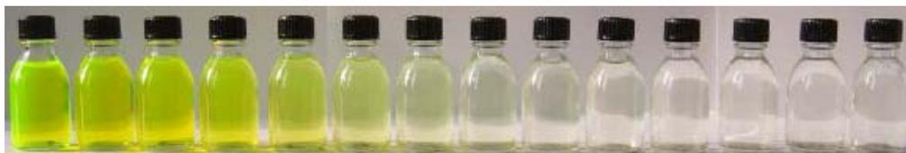
**Figura 64:** Pompando continuamente acqua pulita nell'irroratrice, ed al contempo spruzzando la miscela residua attraverso gli ugelli, si ottiene rapidamente un'elevata diluizione di quest'ultima. I campioni raffigurati qui sopra [da sinistra a destra, dall'inizio alla fine della procedura] testimoniano visivamente questo beneficio. (Foto: Harald Kramer. Prove di lavaggio svolte nell'ambito del Progetto TOPPS.)
