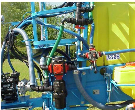
**Figura 34: Esempio di circuito idraulico caratterizzato da elevata lunghezza delle tubazioni e dalla presenza di numerose curve delle tubazioni stesse.**
