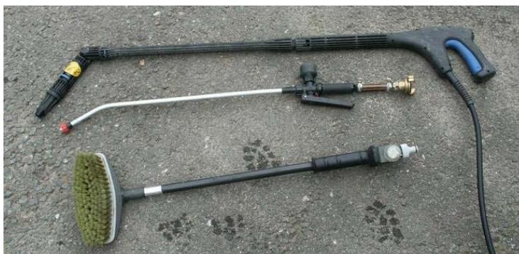
**Figura 52:** Esempi di dispositivi per il lavaggio esterno delle irroratrici: dall'alto idropulitrice, lancia a mano, lancia a mano con spazzola (foto JKI).
