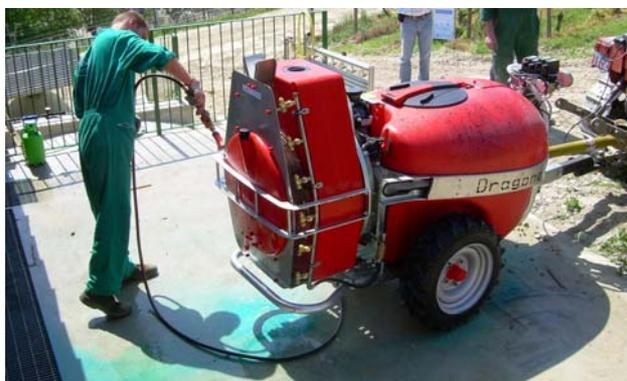
**Figura 21:** *Lavaggio dell'irroratrice su area attrezzata con impiego di una lancia a mano alimentata dalla rete idrica aziendale.*
