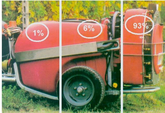
**Figura 41:** Ripartizione dei depositi di miscela fitoiatrica sulle superfici esterne dell'irroratrice: la maggior parte sono concentrati in prossimità del ventilatore (prove DEIAFA).
