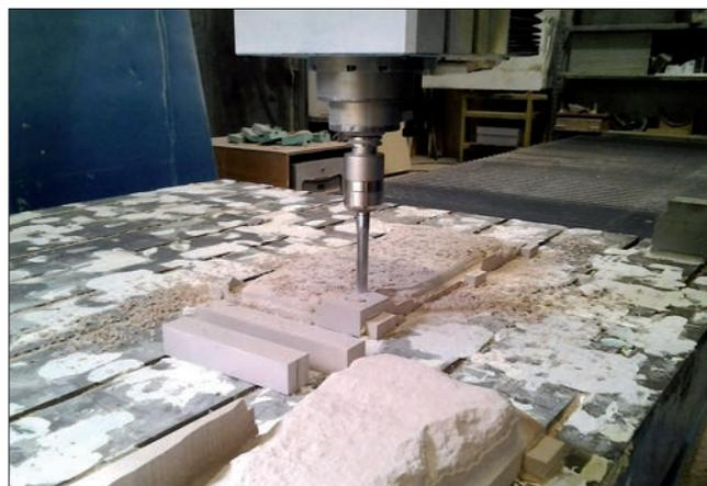
2.-3. La macchina fresatrice CNC a cinque assi e il poliuretano estruso RAKU-TOOL SB-0470 durante le operazioni di fresatura.
