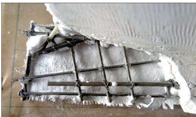
7. BM 33511. Dettaglio dell'armatura di sostegno.
