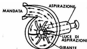
Figura 9 – pompa centrifuga a pale radiali
