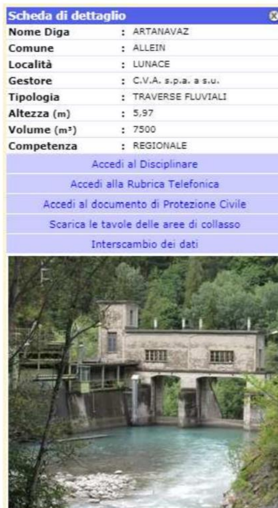
Fig. 13 – “Scheda di dettaglio” dello sbarramento
