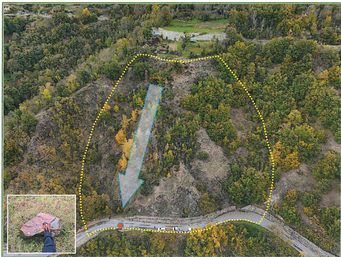
FOTO 1: veduta aerea della zona di intervento (tratteggio giallo) con indicata la nicchia di distacco (tratteggio rosso), la traiettoria di caduta (tratteggio azzurro) e il punto di arresto del blocco (punto rosso)
