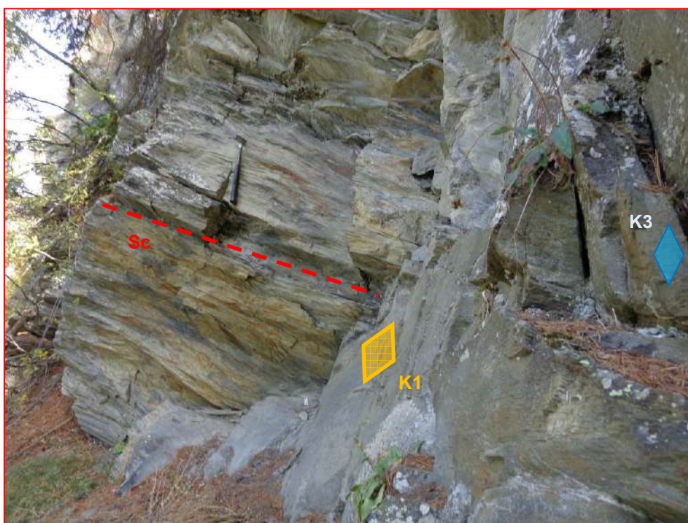
Fig. 22 – Assetto strutturale, con la scistosità principale e le discontinuità del sistema K1 e K3
