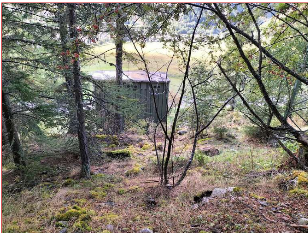
Fig. 11 – Pendio a monte della Cabina DEVAL e del previsto manufatto. Depositi detritico - colluviali a mascheramento di antichi depositi detritici gravitativi. Sono riconoscibili blocchi in parte emergenti, ricoperti di muschio, di volumetria compresa tra 1 m 3 e 3 m 3
