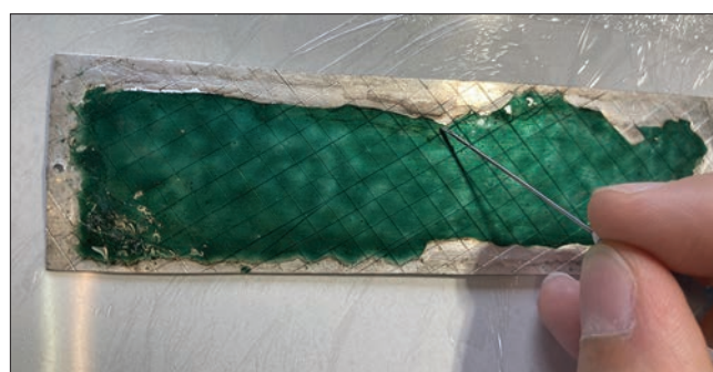
40a.-c. Il forte degrado delle placchette smaltate causato dai residui di sostanze detergenti e paste abrasive utilizzate in precedenti puliture (in alto a sinistra). La ricomposizione dei frammenti (in alto a destra). Il consolidamento dello smalto sui bordi (in basso). (V. Borgialli)
