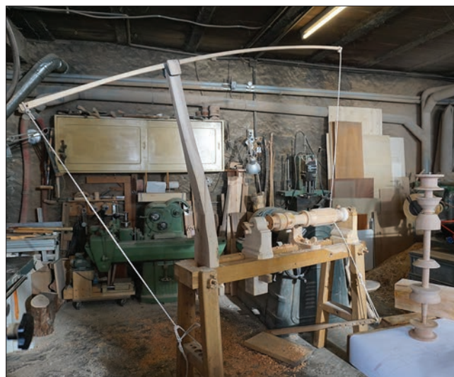
2. Il tornio a pertica nel laboratorio di Rudy Mehr. (P. Allemani)
