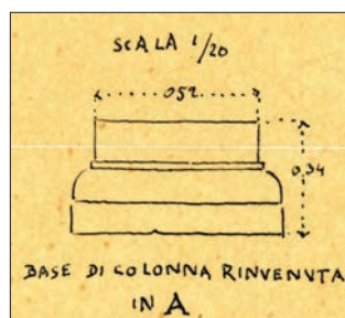
4. Particolare della base di colonna rinvenuta nel giardino dell'Ospedale Mauriziano.
