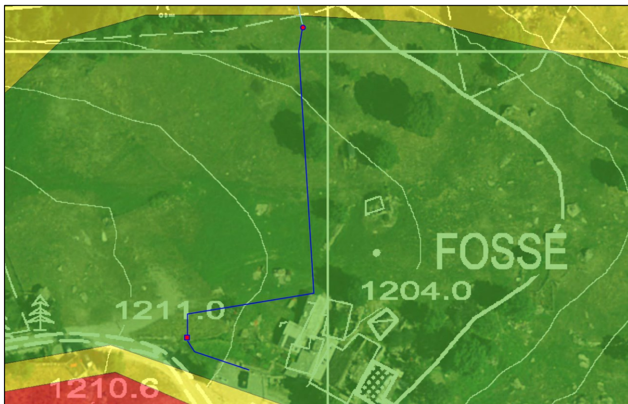
FIGURA 6-2 DETTAGLIO CARTOGRAFIA DEGLI AMBITI INEDIFICABILI PER TERRENI SEDI DI FRANE SETTORE FUSSE (ART.35/1 – L.R. 11/98)
