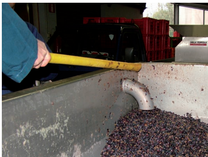
Dettagli del polmone di alimentazione delle linee di vinificazione
