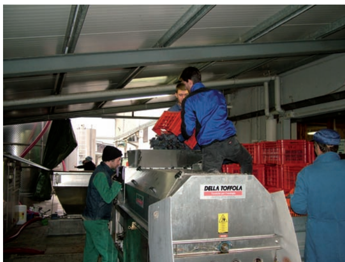
Particolare di scarico manuale nella tramoggia della diraspatrice
