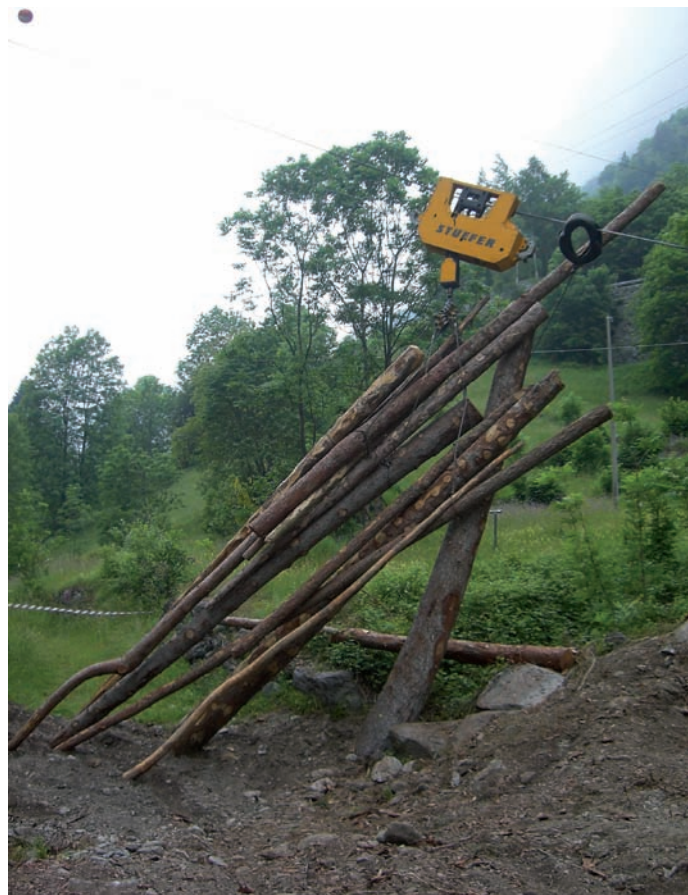
Esbosco con gru a cavo – Trambesère – Pontboset
