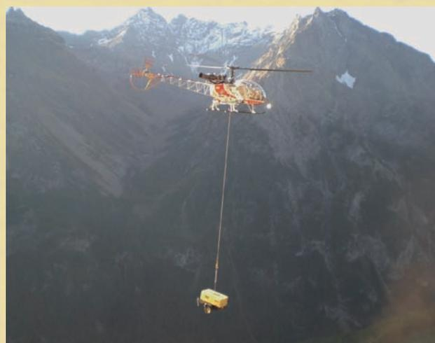
Foto 1 – Trasporto di un compressore nell'area di cantiere
