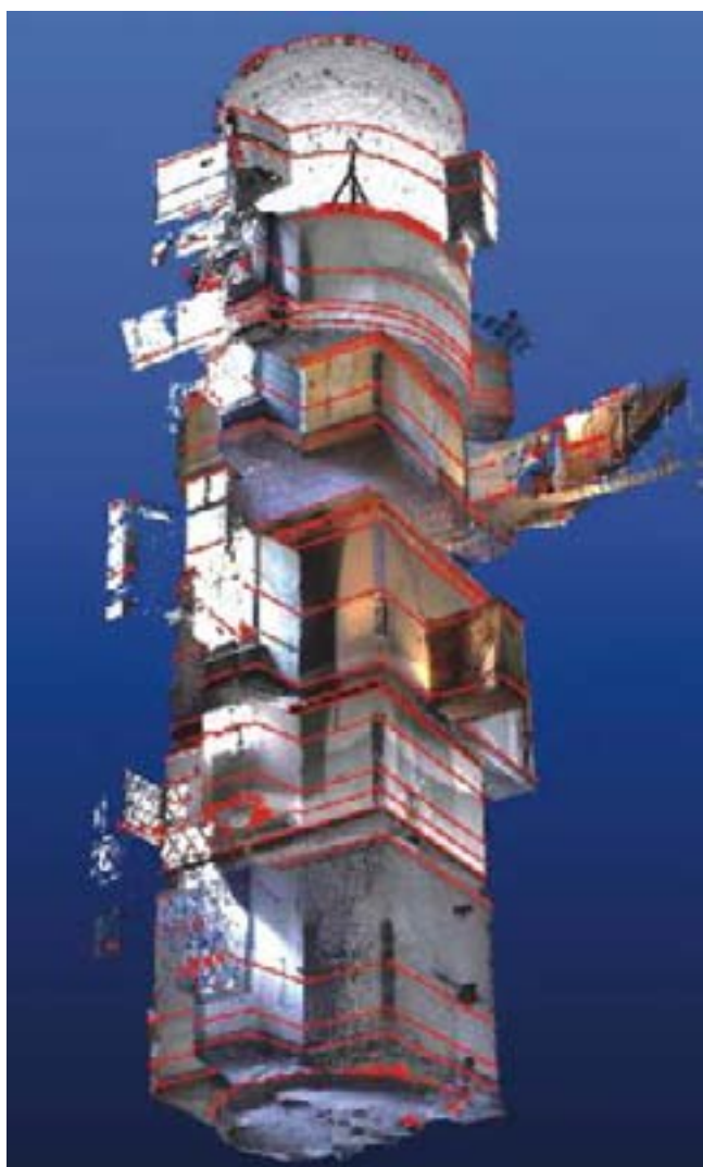
10. Rilievo tridimensionale con tecnologia laser-scan della torre nord-est. (3D Survey, R. Focareta)
