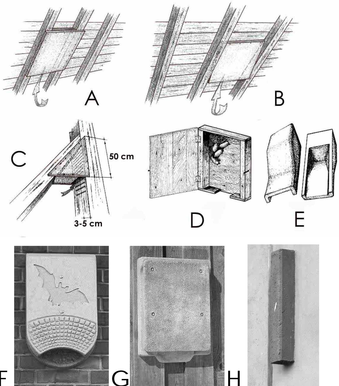
Fig. 13. Creazione di interstizi per i pipistrelli utilizzando tavole in legno grezzo (A, B, C) o ricorrendo a *bat board* in legno (D, sportello di almeno 30x20 cm, spazio interno profondo 2-3 cm), materiale refrattario o cemento-segatura (E, F, G, H).
