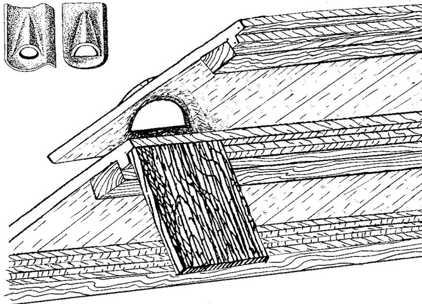
Fig. 5. Creazione di un punto d'accesso "in arrampicata" ad un sottotetto, abbinando una tegola d'aerazione e una tavola di legno grezzo.
