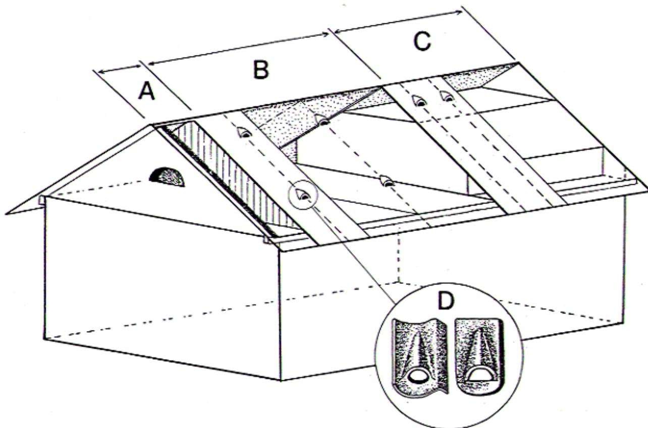
**Fig. 4. Accorgimenti per conservare i siti di rifugio in caso di interventi nei sottotetti: suddivisione verticale (fra A e B) e orizzontale (C) del volume interno; utilizzo di tegole di aerazione (D).**
