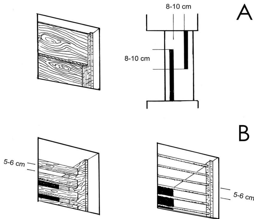
Fig. 6. Accessi per consentire il passaggio dei pipistrelli ed escludere quello dei piccioni (cfr. testo).
