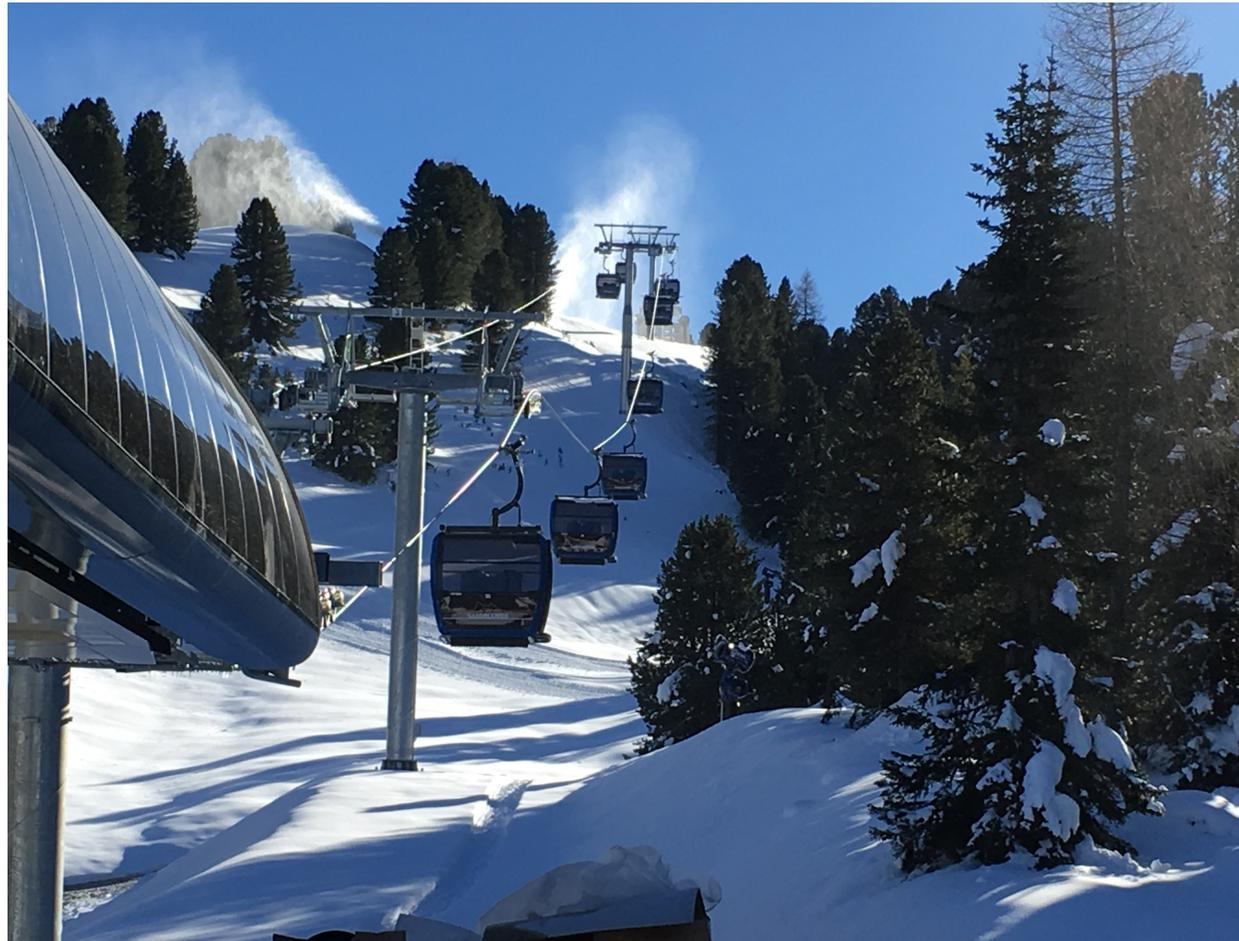
**Prove a carico – Pieno carico squilibrato in discesa (6 cabine cariche nel ramo discesa, nessuna cabina in stazione, 6 vetture cariche in salita)**
