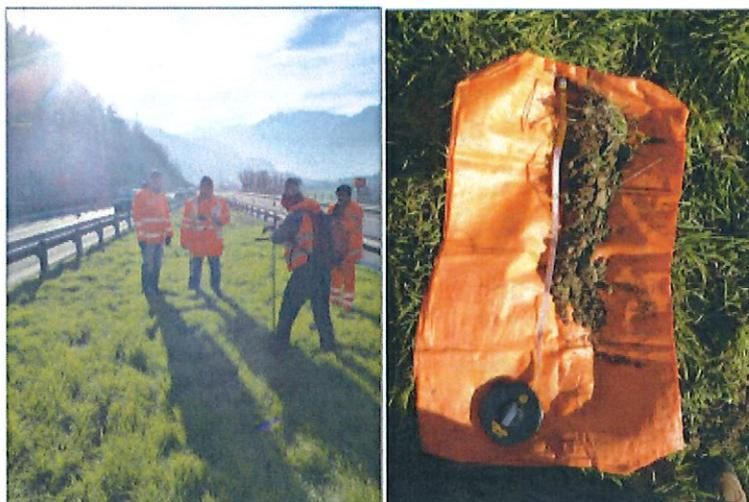
Figura 12: Campionamento effettuato con trivella manuale(sinistra) e terreno campionato (destra).
