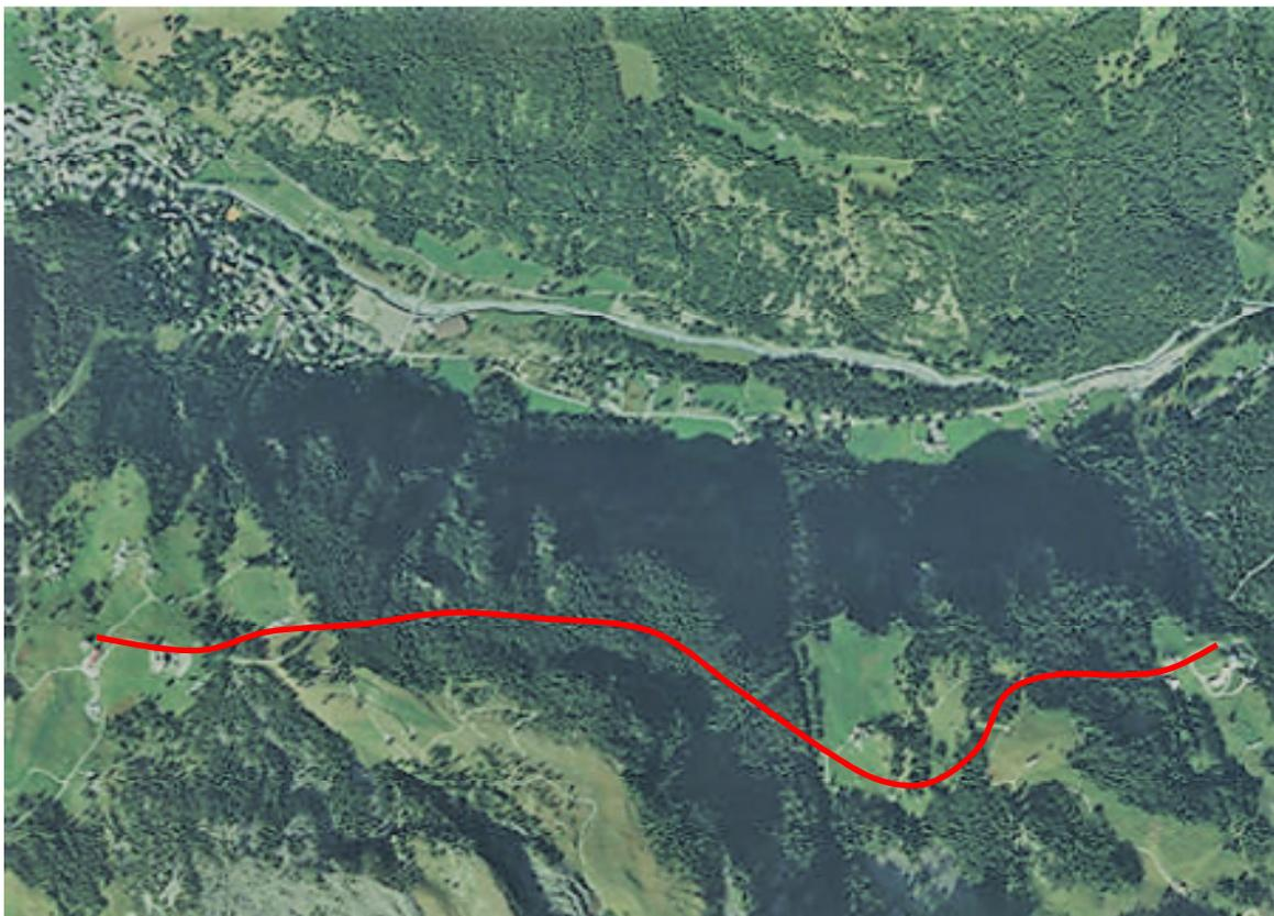
**Figura 2** – Planimetria degli interventi con ubicazione del nuovo tratto di linea interrata (tratteggio rosso) in progetto. Le cabine elettriche collegate dalla linea interrata sono ubicate in edifici esistenti.
