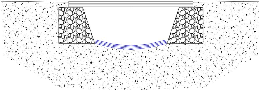
NB: i travi devono poggiare in maniera abbondante sulle spallette, senza oltrepassare le stesse
