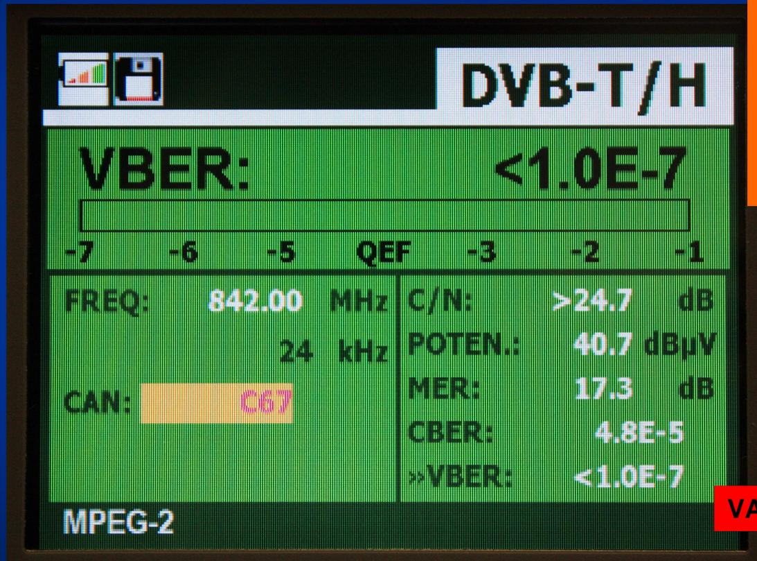
Il valore del VBER misurato  $1E-7$  indica che gli errori contenuti nel segnale sono stati sufficientemente corretti.
