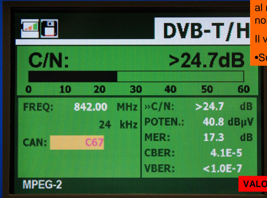
Il valore del C/N misurato 24,7 è appena superiore al minimo stabilito dalle norme.
