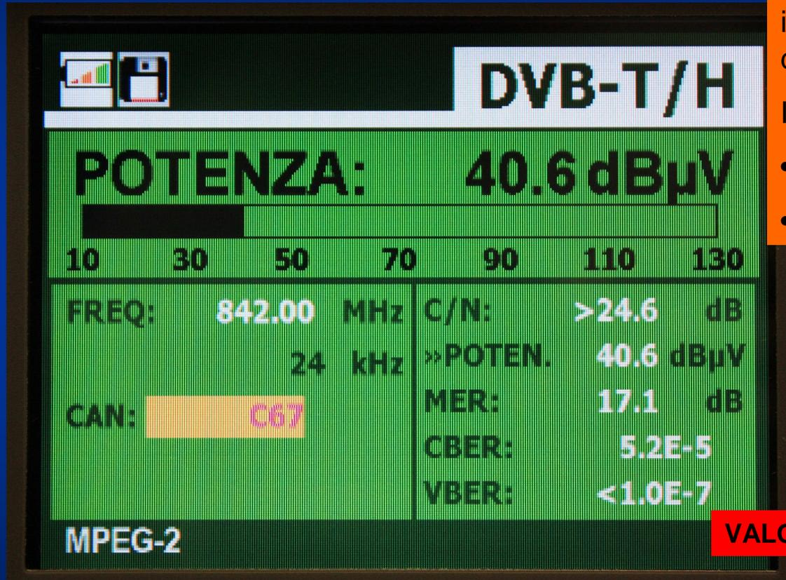
Il valore della potenza misurata 40,6 dB $\mu$ V , è inferiore al minimo stabilito dalle norme.
