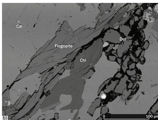
5. Microfotografie in elettroni retrodiffusi. a) Immagine d'insieme relativa all'alternanza di livelli a dolomite+calcite e livelli a calcite.
