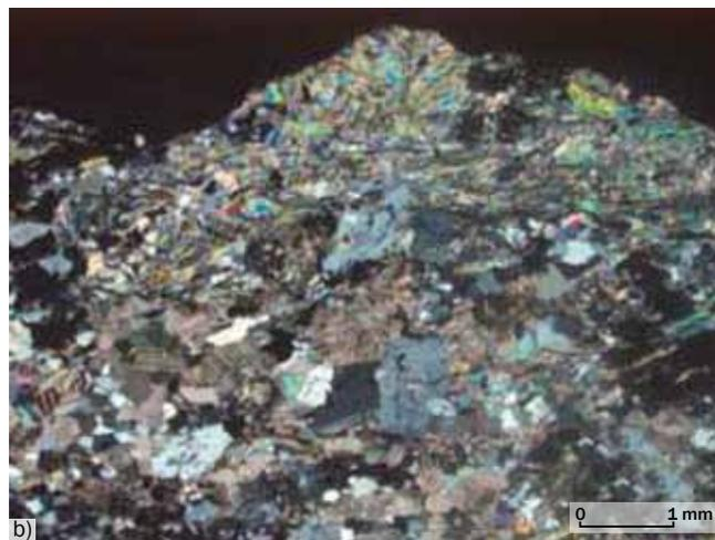
7. a) Microfotografia in elettroni retrodiffusi relativa alle miche isolate e caratterizzate da orientazione preferenziale dimensionale. b) Fotografia in microscopia ottica (polarizzatori incrociati) di un particolare relativo ad un cristallo di albite pecilitica. (V. Rubinetto)
