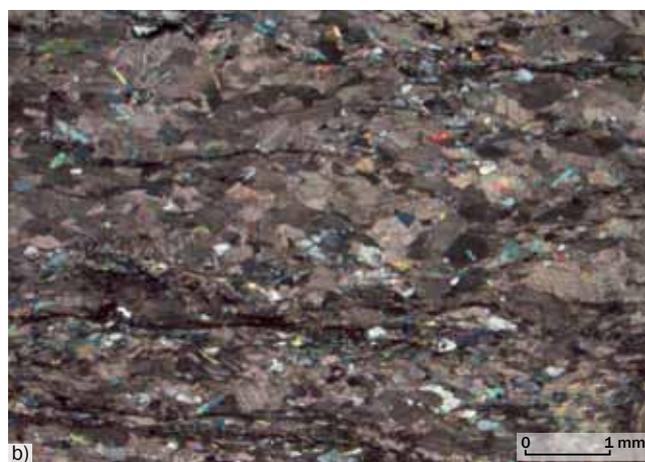
3. Immagini in microscopia ottica rappresentative del marmo impuro foliato a silicati della Zona Piemontese Interna, stele 35, sez. sott. C16; a) solo polarizzatore, b) polarizzatori incrociati. (M. Serra)
