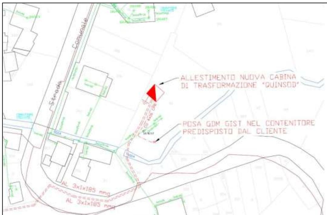
**FIGURA 3-2** ESTRATTO DEL PROGETTO DI CONNESSIONE DELLA NUOVA UTENZA. IL QUADRATO DI COLORE ROSSO RAPPRESENTA LA NUOVA CABINA
