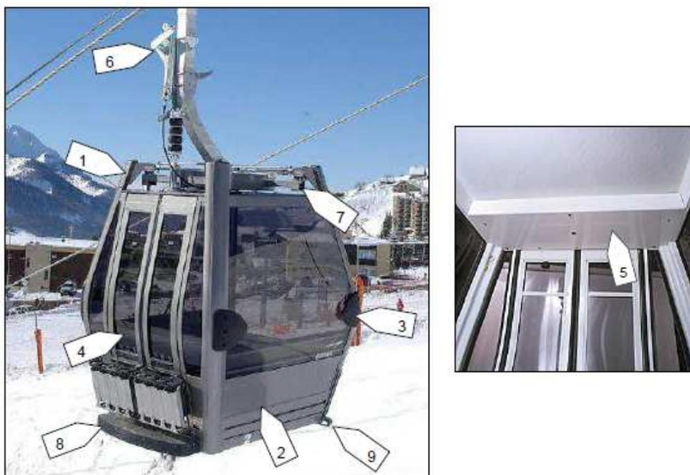
**Figura 87 – Posizione degli elementi della cabina**
