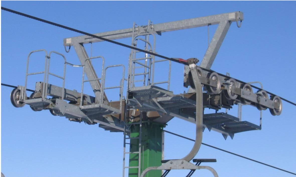
Figura 68 – Testata di sostegno di appoggio
