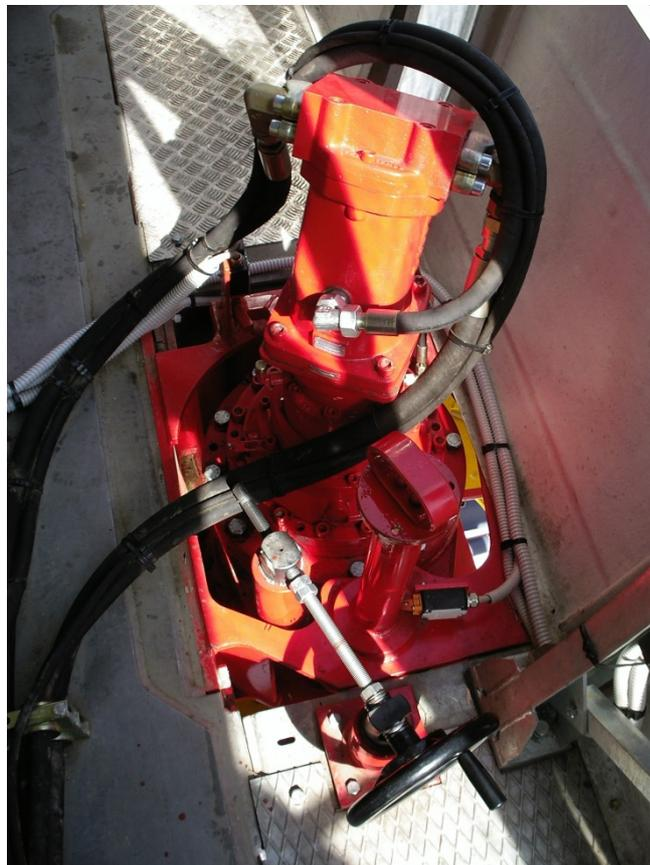
**Figura 19 – Motore idraulico di organo di recupero**
