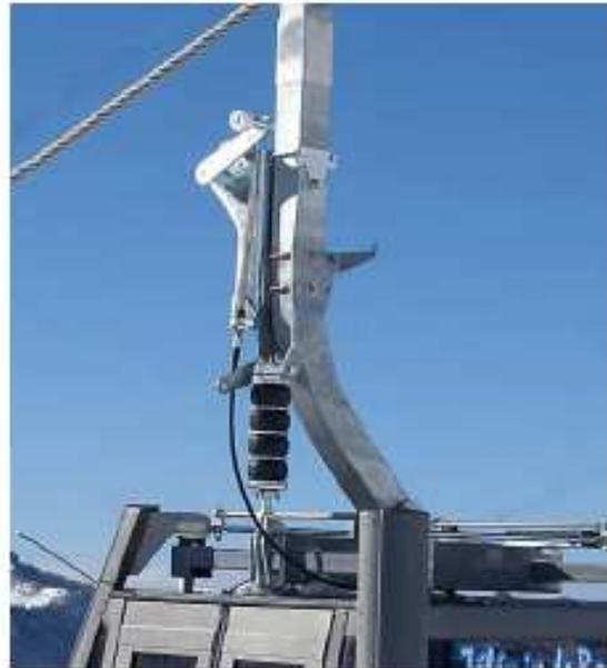
**Figura 88 – Meccanismo di comando delle porte**
