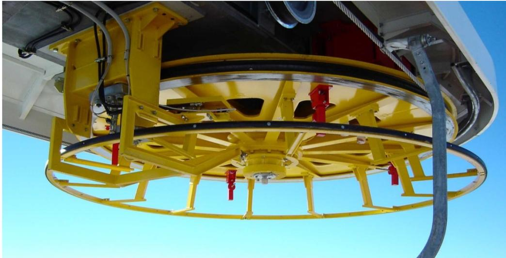
Figura 22 – Puleggia motrice dotata di pendoli centrifughi (in rosso)
