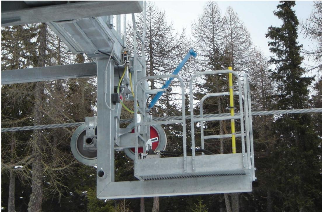
Figura 94 – pedana di manutenzione
