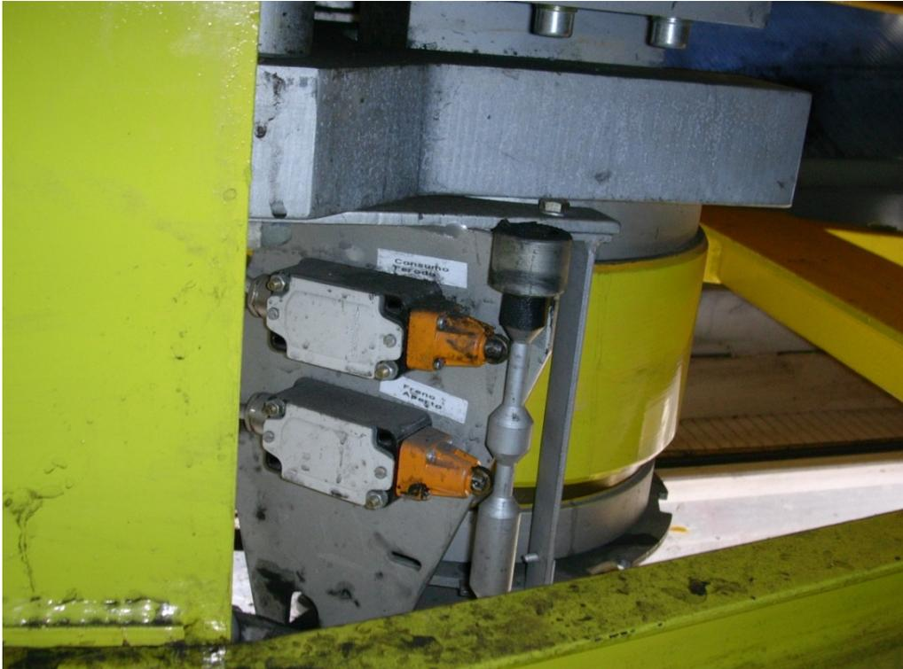
**Figura 29 – Posizionamento dei finecorsa FE**
