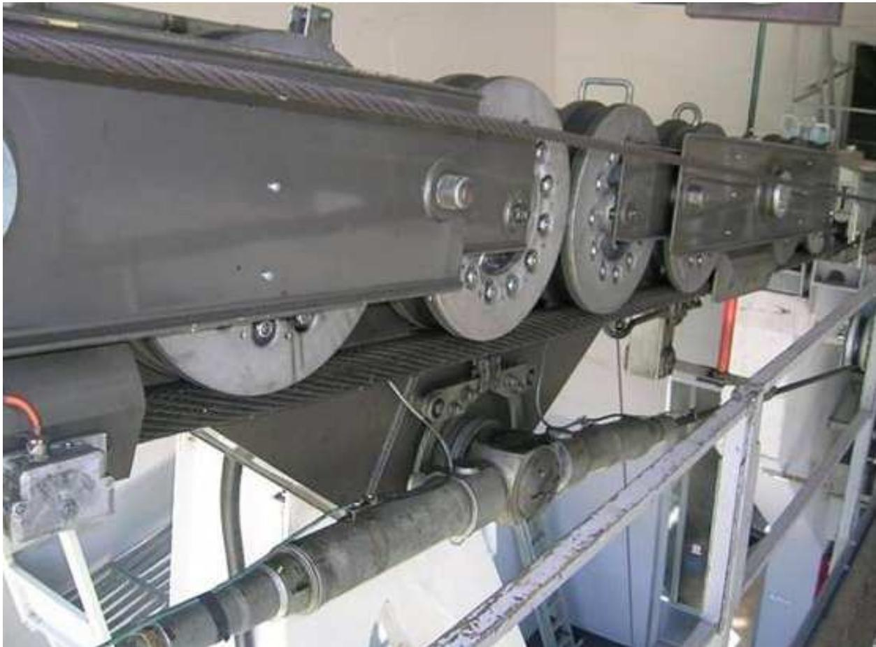
**Figura 135 – Carrello con sistema di attacco a teste fuse**
