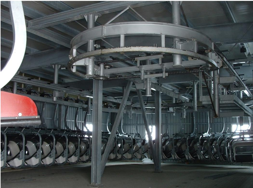
**Figura 43 – Magazzino di una seggiovia ad agganciamento automatico**
