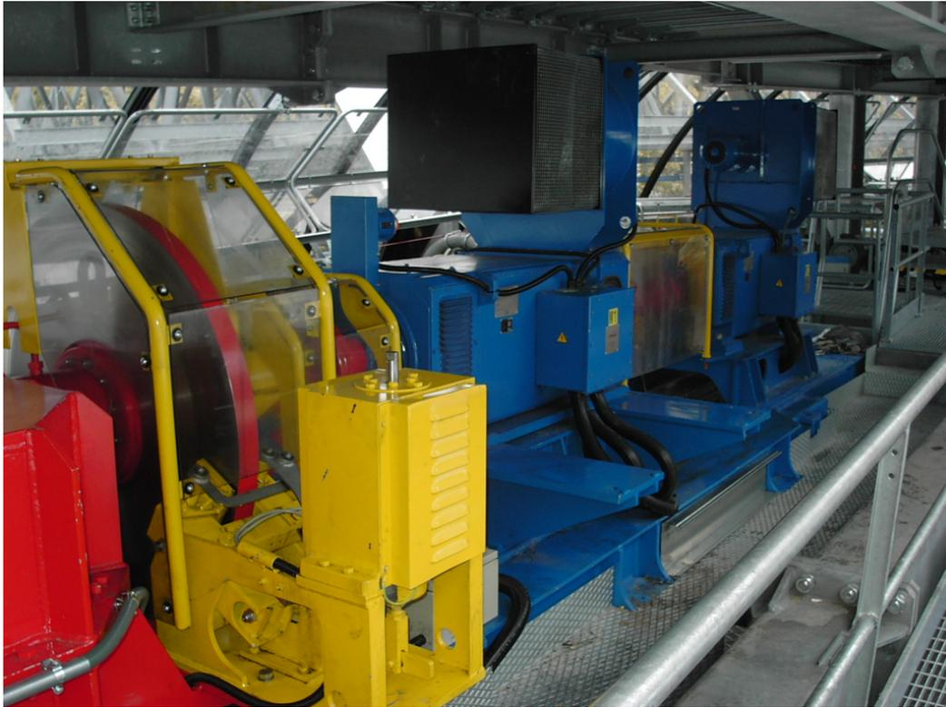
**Figura 16 – Motori e freno meccanico di un impianto ad agganciamento automatico**
