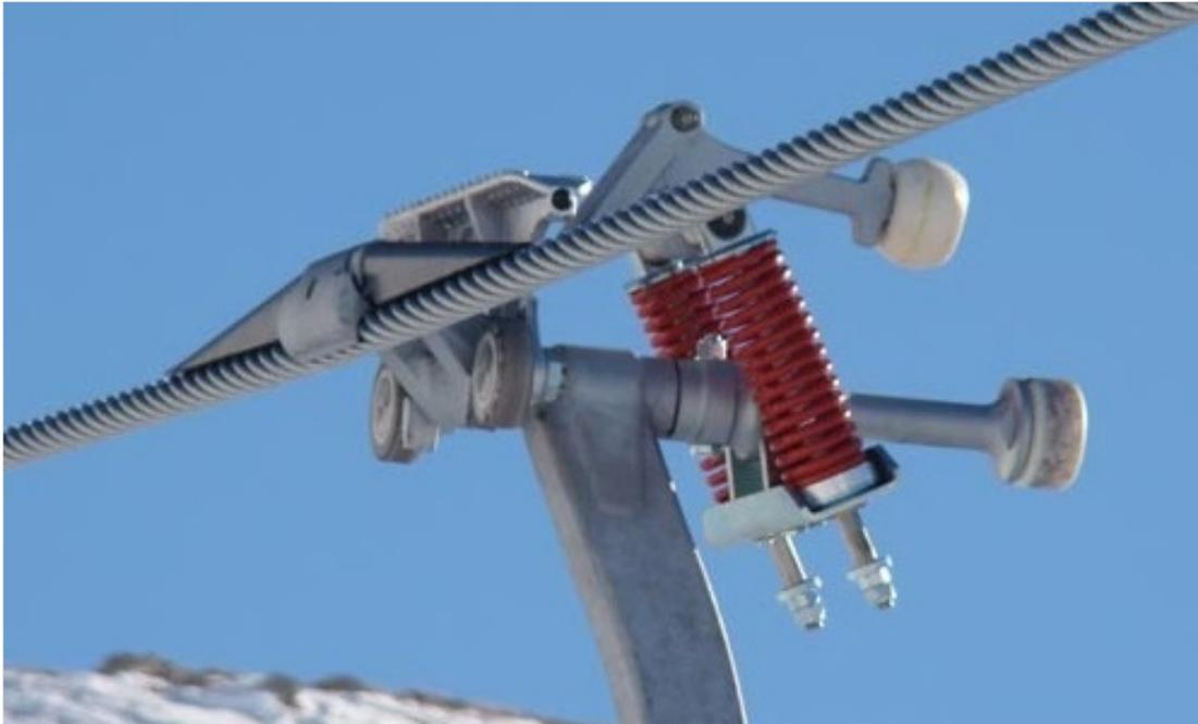
**Figura 84 – Morsa di un impianto ad agganciamento automatico**
