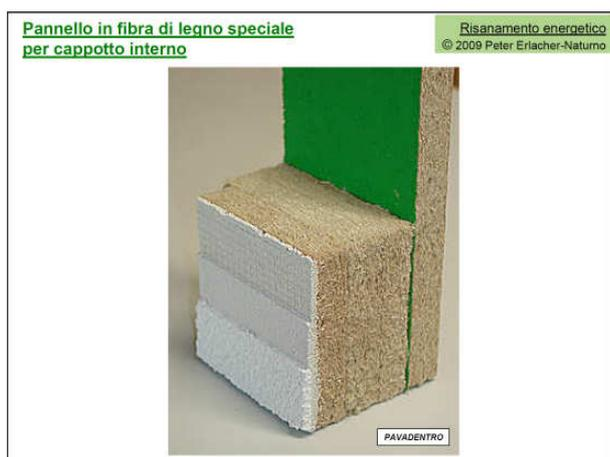
Pavadentro ha uno strato interno di tipo minerale che permette la diffusione controllata dell'umidità e grazie all'alta capacità igroscopica della fibra di legno garantisce un'elevata qualità interna dell'aria. Lo spessore del cappotto interno è consigliabile tenerlo entro 6 cm. Inoltre è meglio verificare il punto di condensa per non avere brutte sorprese.
